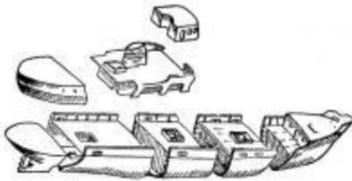
Рис. 61. Сборка корпуса судна из блок-секций.
