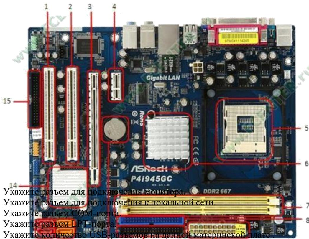
Укажите разъем для подключения монитора.
