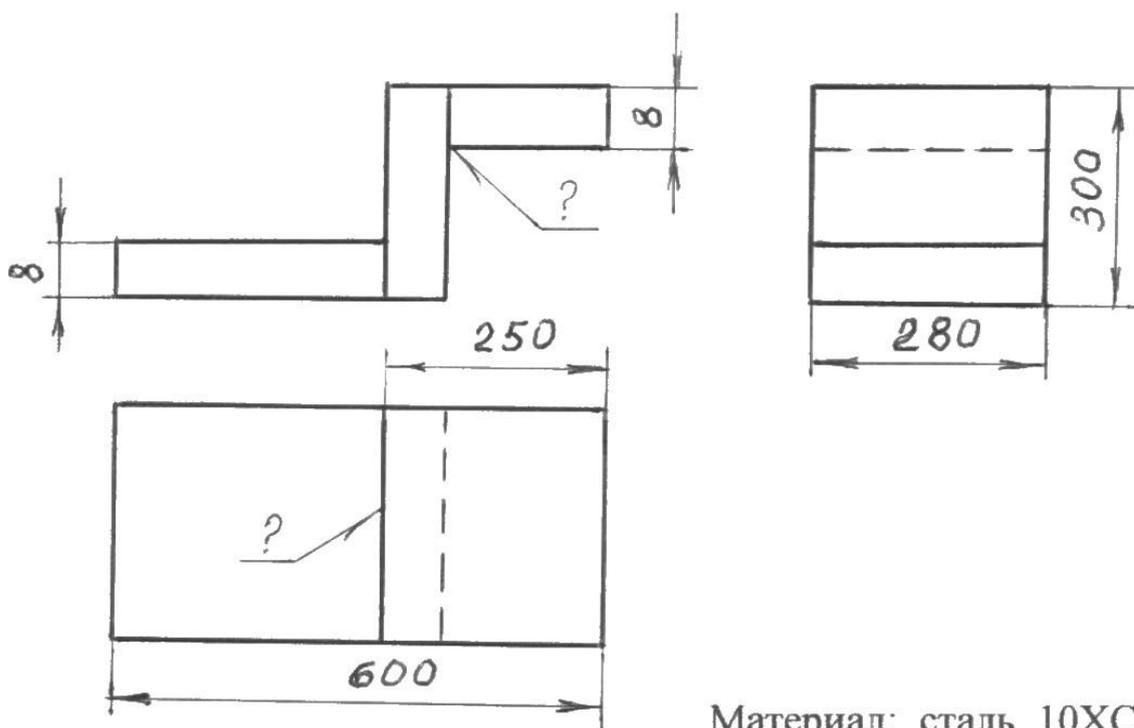
1 По чертежу определить тип сварного соединения деталей, положение шва в пространстве
