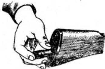
**Отделить шомпол.** Оттянуть конец шомпола от ствола так, чтобы его головка вышла из-под упора на основании мушки, и вынуть шомпол вверх. При отделении шомпола разрешается
