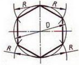
Разделить окружность на 3 и 6 равных частей
