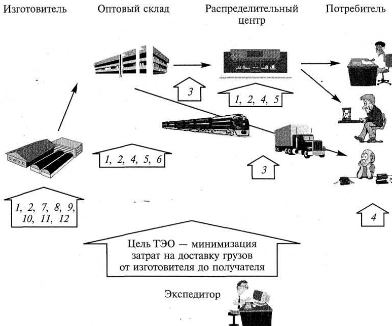
Рис. 3.1. Взаимосвязь транспортного процесса доставки товара и транспортно-экспедиционной деятельности: 1) подготовка груза к перевозке (проверка качества, количества груза, упаковывание, маркировка и т.д.); 2) погрузка груза на ПС; 3) перегрузка груза с одного вида транспорта на другой; 4) разгрузка груза; 5) промежуточное хранение груза (формирование, расформирование и переформирование отправок); 6) складирование груза; 7) выбор рационального варианта доставки груза потребителю; 8) расчет стоимости доставки груза; 9) осуществление расчетов с потребителями груза; 10) контроль продвижения груза; 11) выполнение консалтинговых операций; 12) оформление транспортной и товаросопроводительной документации
