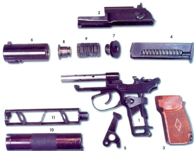
Рис. 5.4. Неполная разборка пистолета ПБ:
