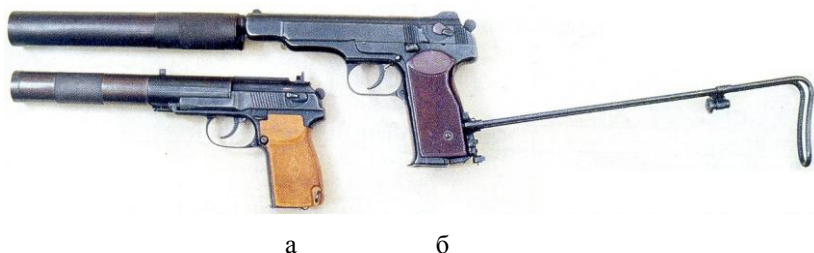
Рис. 5.3. а – самозарядный пистолет ПБ; б – автоматический пистолет АПБ
