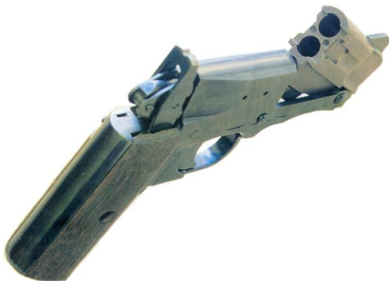
Рис. 10.7. Пистолет под патроны СП-3, стволы открыты
