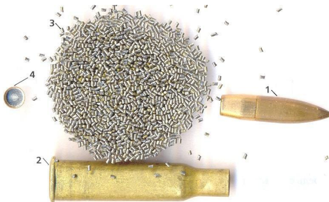
Рис. 2.3. Составные части патрона: 1 – пуля; 2 – гильза; 3 – метательный заряд (порох); 4 – капсюль-воспламенитель
