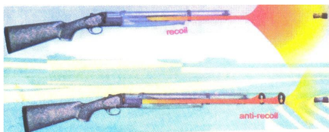
Рис. 9.3. Схема работы глушителя дробовика компании Laporte
