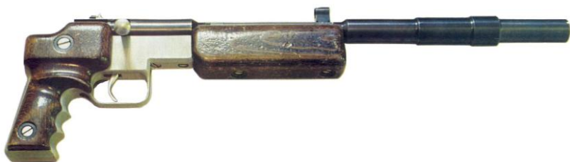
Рис. 10.5. Самодельное ружье калибра 5,6-мм
