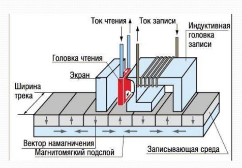
• Кроме того, данная технология обеспечивает возможность получения более высокой амплитуды и более коротких импульсов записывающего поля, отсутствие размагничивающих полей на битовых переходах, более высокой амплитуды сигнала при считывании.
