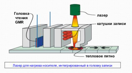
Термоассистирующая запись имеет ещё больше отличий от традиционной технологии, поскольку здесь применяется комбинация магнитной записи с локальным лазерным нагревом перемагничиваемой области.
