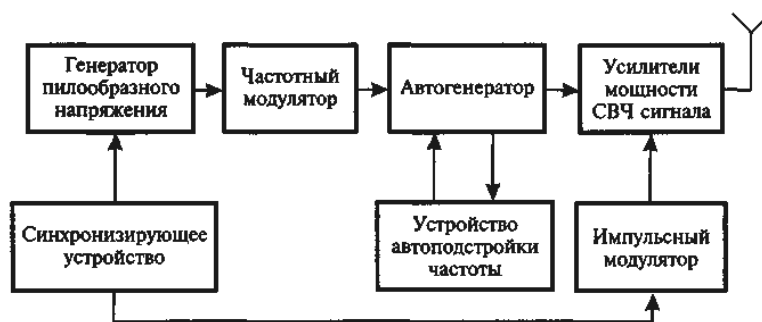
Рис. 23.14. Структурная схема РПДУ ИМ и ЧМ с синхронизацией ИМ и ЧМ
