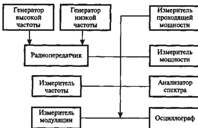
Рис. 29.1. Обобщенная структурная схема стенда по измерению параметров радиопередатчиков малой и средней мощности
