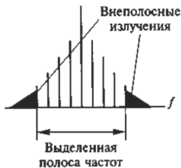
Рис. 19.1. Допустимая полоса излучения спектра модулированного сигнала
