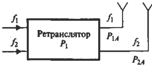
Рис. 13.8. Передача информации через общий ретранслятор на двух частотах
