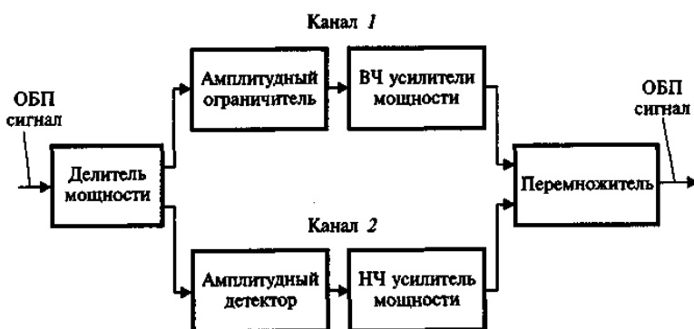
Рис. 20.4. Схема двухканального усилителя для раздельного усиления сигналов с фазовой и амплитудной модуляцией
