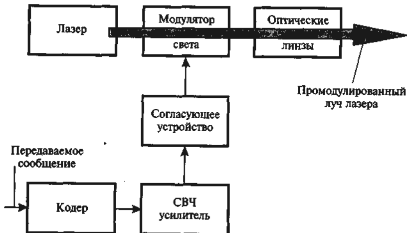
Рис. 28.2. Структурная схема оптического передатчика
