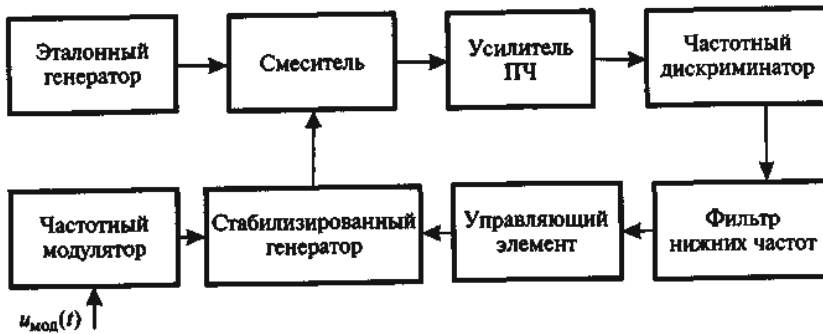
Рис. 21.8. Структурная схема АФЧ автогенератора с подключенным к нему частотным модулятором
