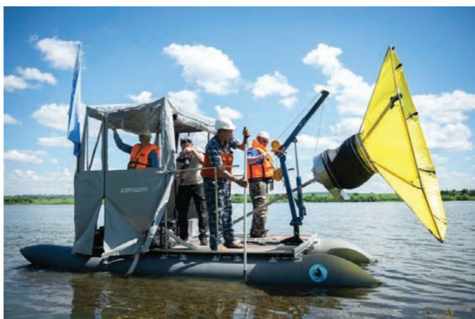
Рис. 3. Работы по технологии очистки водоемов от донных загрязнений нефтью и микропластиком («Аэрошуп»)
