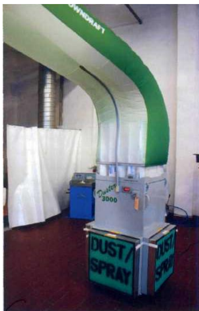
Рис. 34. Мобильный пост подготовки автомобиля к покраске
