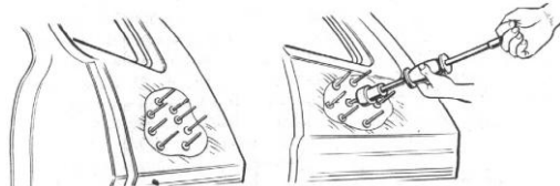
Рис. 26. Устранение вмятин приспособлением ударного типа
