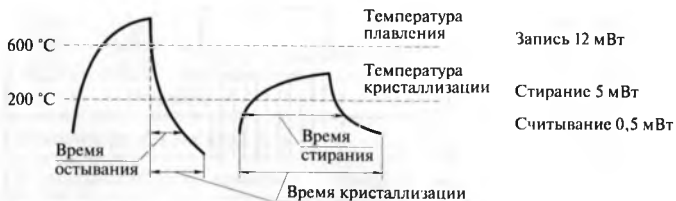
Рис. 7.13. Запись, стирание и считывание информации с CD-RW-дисков
