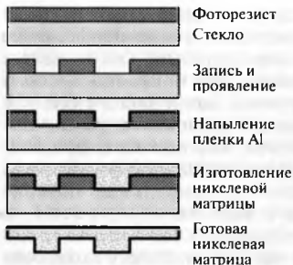
Рис. 7.8. Процесс изготовления никелевой матрицы
