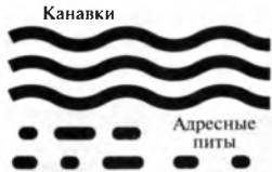
Рис. 7.10. Волнообразные канавки и служебные питы на поверхности оптических дисков
