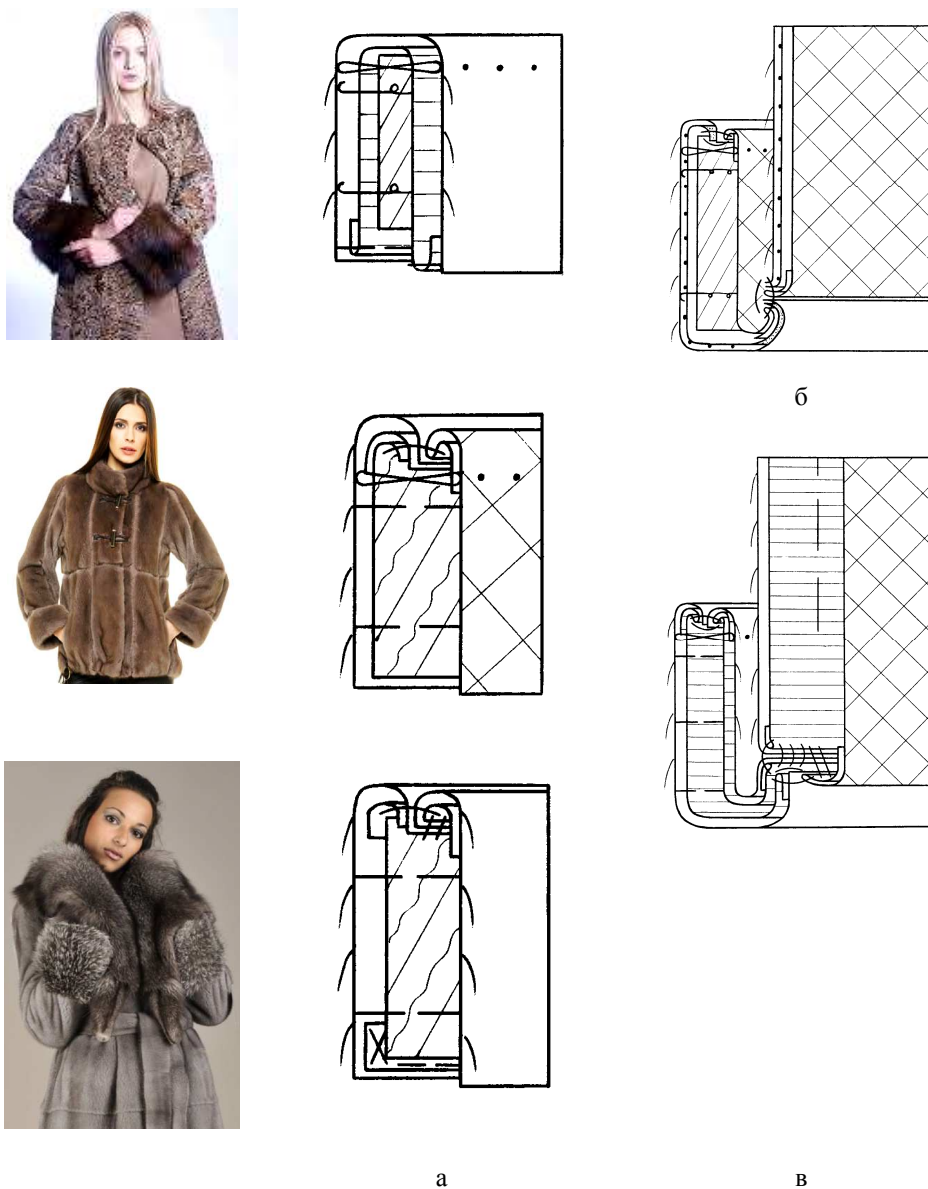
Рис. 1.25. Конструкция технологического узла манжеты: а – варианты обработки манжет; б – соединение притачной манжеты с рукавом; в – соединение отложной манжеты с рукавом
