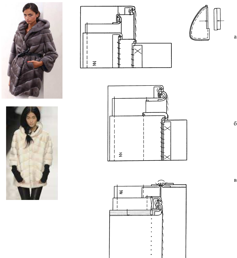
Рис. 1.19. Монтажная схема конструкции карманов: а – прорезного кармана «в щель»; б – прорезного кармана «в кант»; в – кармана в шве
