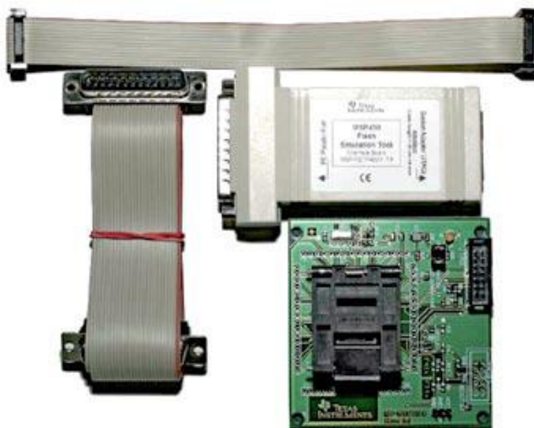
Рис. 6.25. Комплект для отладки и программирования микроконтроллеров MSP430F41X компании Texas Instruments
