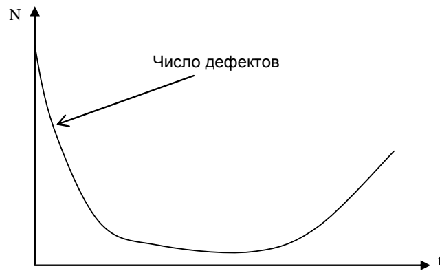
Рис. 8.3. Изменение количества дефектов в техническом устройстве с течением времени
