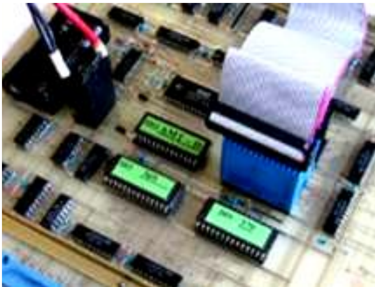
Рис. 5.29. Подключение к микросхемам с помощью разъема типа «клипса»
