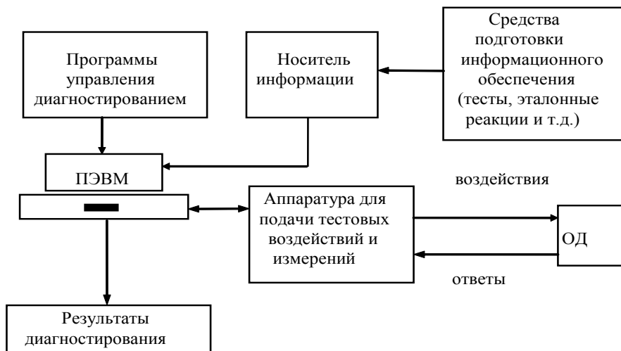
Рис. 1.4. Структурная схема современной системы тестового диагностирования
