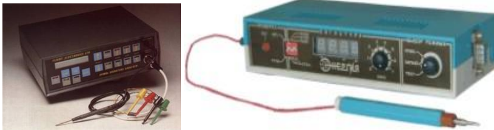
Рис. 6.17. Примеры сигнатурных анализаторов, выполненных в виде автономных устройств
