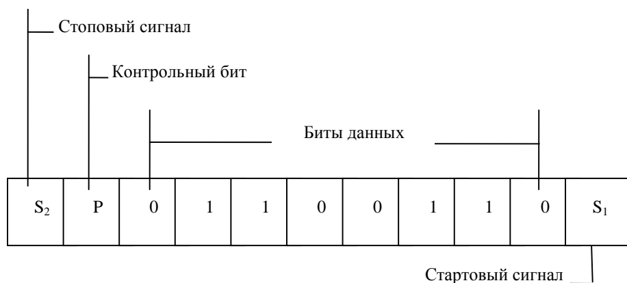
Рис. 7.3. Формат данных при передаче через последовательный порт
