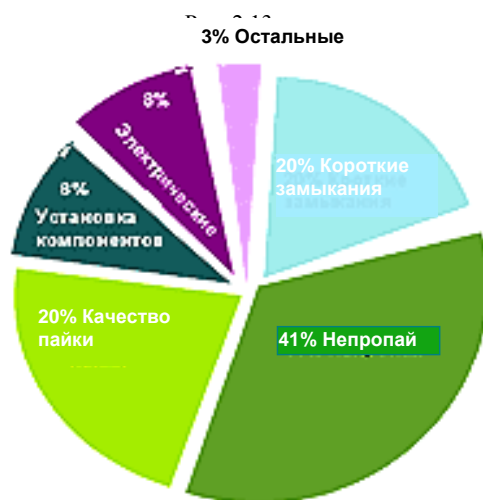
Рис. 2.18. Статистика причин неисправностей при производстве
