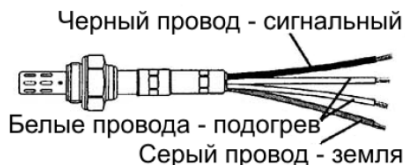
Рис. 7.4. Четырехпроводной кислородный датчик.
