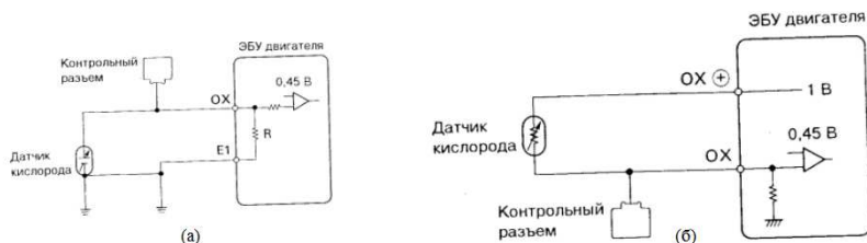
Рис. 7.1. а – схема включения циркониевого кислородного датчика; б – схема включения титанового кислородного датчика
