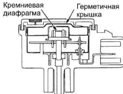
Рис. 6.5. Конструкция датчика абсолютного давления (MAP)
