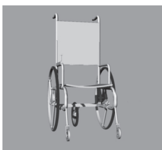
Рис. 6.5. 3D-модель конструкции инвалидного транспортного средства с толкающим мотор-колесом и SOFTWHEEL колесами
