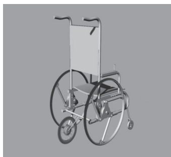
Рис. 6.5. 3D-модель конструкции инвалидного транспортного средства с толкающим мотор-колесом и SOFTWHEEL колесами
