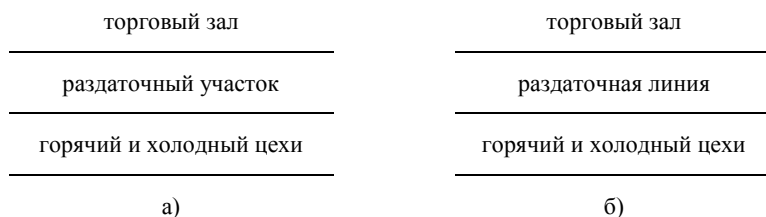
Рис. 7.1. Связь торговых помещений с производственной группой через зону раздаточных: а) обслуживание официантами (рестораны, бары, кафе); б) самообслуживание (столовые, закусочные, предприятия типа fast-food)
