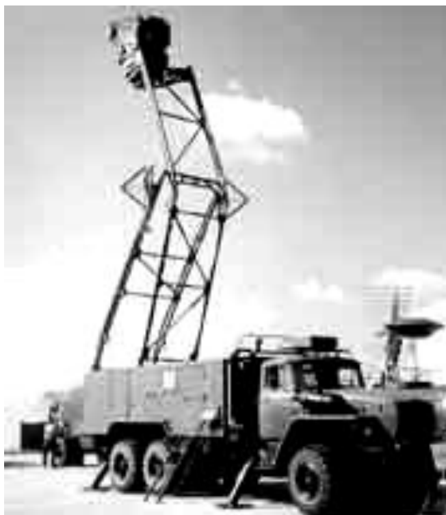
Рис. 10.4. Мобильная автоматическая станция пеленгования и анализа сигналов радиотехнических средств
