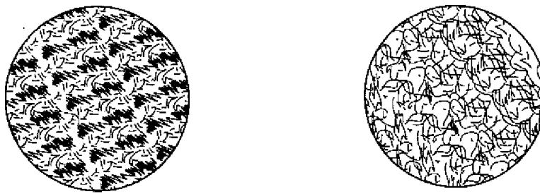
Рис. 4.27. Опорная поверхность ткани: а – саржевого переплетения; б – сукна
