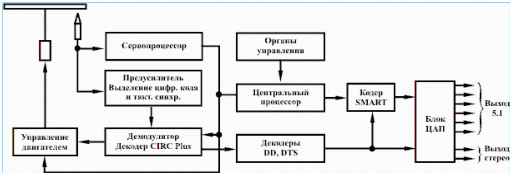
Структурная схема проигрывателя DVD-Audio
