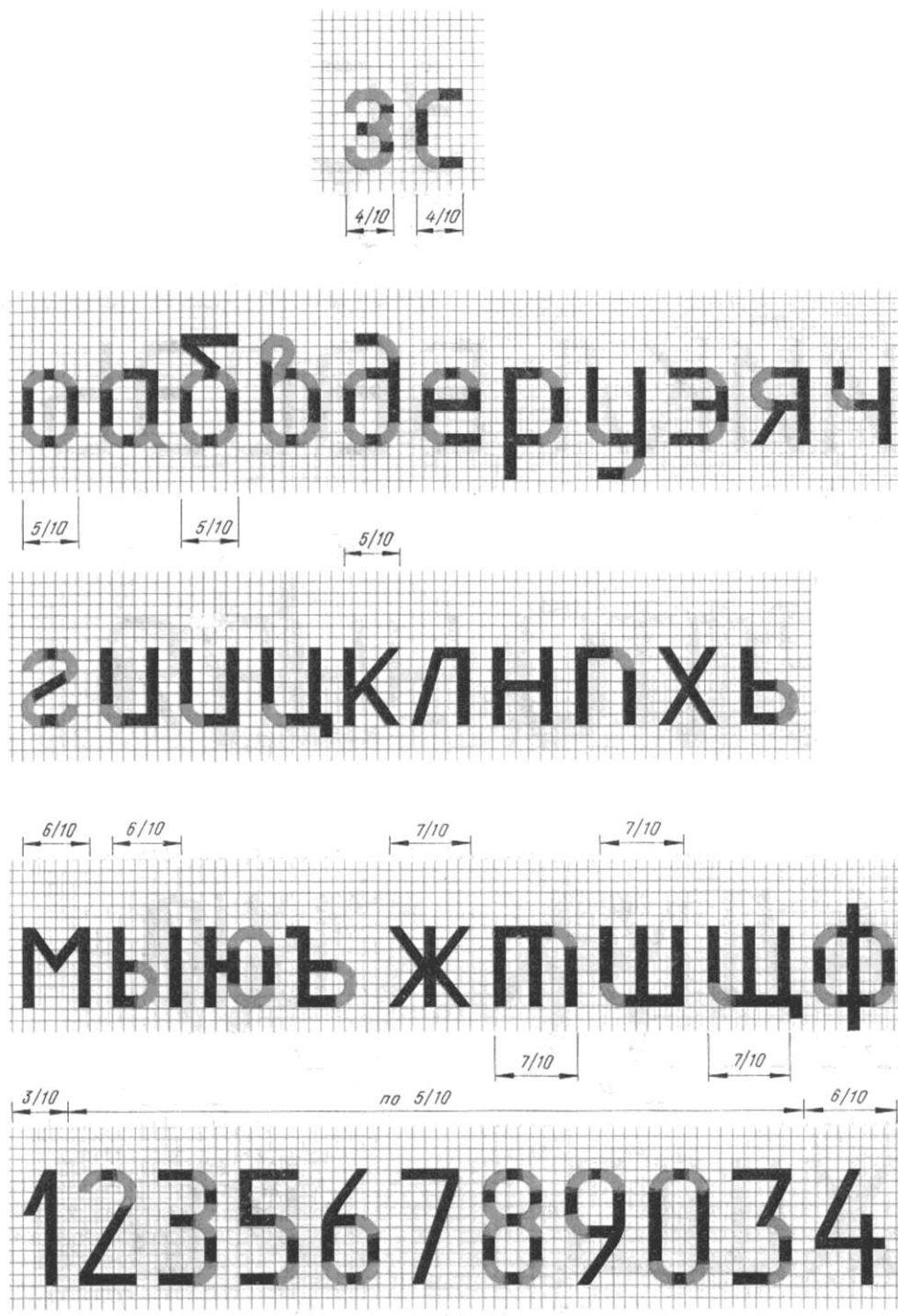
Рис. 1.8. Построение строчных букв шрифта типа Б без наклона, расположенных группами по ширине букв
