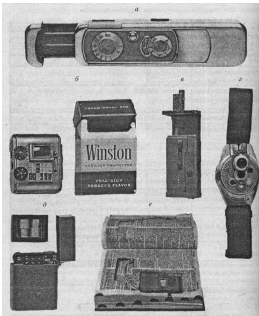
Рис. 29. Фотоаппараты для негласной фиксации информации: а – аппарат Мinox; б - камера Ф-21; в – фотоаппарат «Киев-30»; г – фотоаппарат в ручных часах; д – фотоаппарат в зажигалке; е – фотоаппарат в книге
