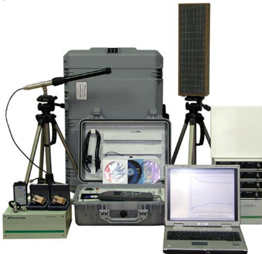
Рис. 47. Система оценки защищенности выделенных помещений по виброакустическому каналу "ШЕПОТ"
