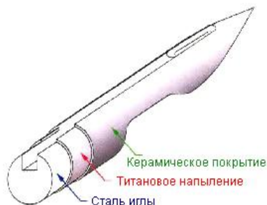
Рис. 9. Машинная игла с титановым напылением и керамическим покрытием
