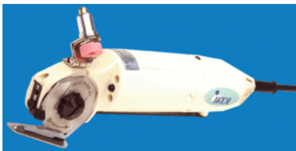
Рис. 14. Электрические раскройные ножницы марки KM RS-50 Birdie (Япония)
