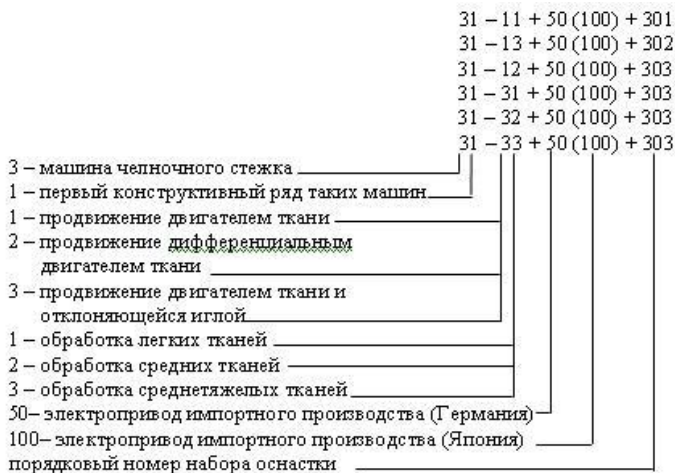
Рис. 1. Условное обозначение машин конструктивно-унифицированного ряда 31
