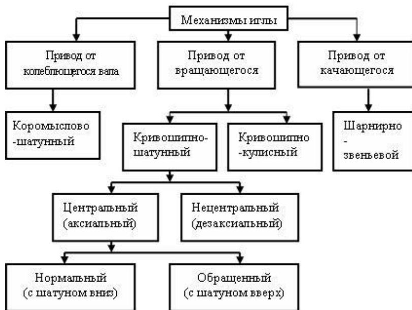
Рис. 7. Классификация механизмов иглы
