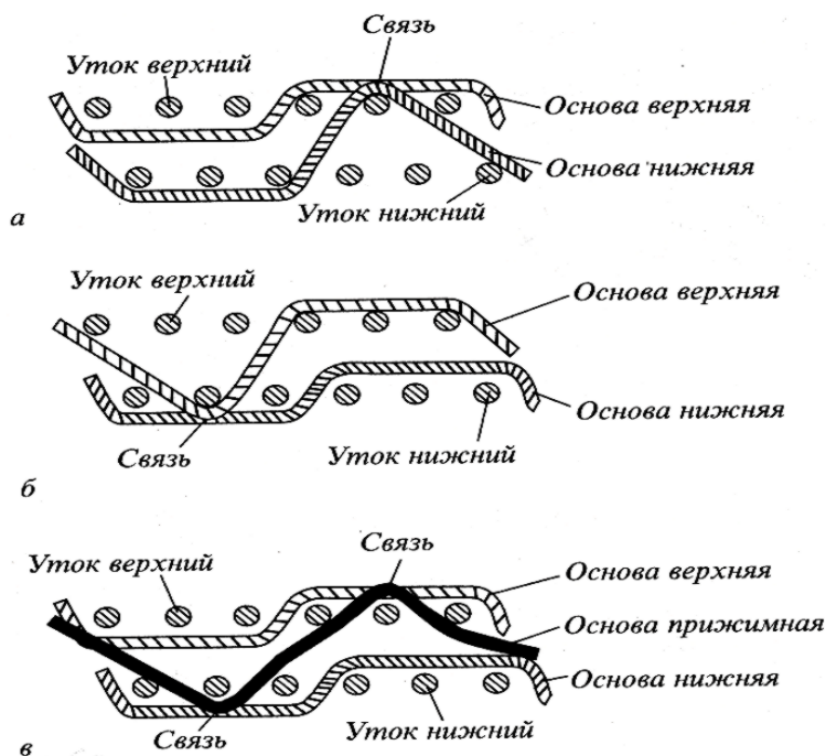
Рис. 64. Разрез ткани двухслойного переплетения с разными способами связи полотен: а – нижняя основа над верхним утком; б – верхняя основа под нижним утком; в – связь полотен с помощью прижимной основы
