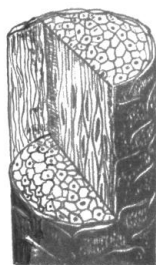
Рис. 9. Схема расположения веретенообразных клеток в корковом слое пухового волокна
