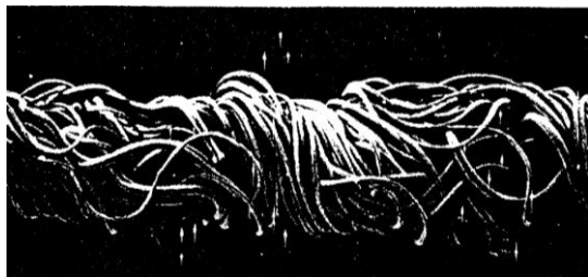
Рис. 18. Пряжа, состоящая из волокнистого сердечника и оболочки (оплетки) из тонких волокон
