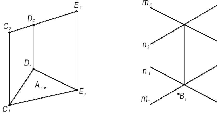
29. Изобразить одно из положений точки  $A$ , расположенной перед плоскостью, точки  $B$ , расположенной за плоскостью.
