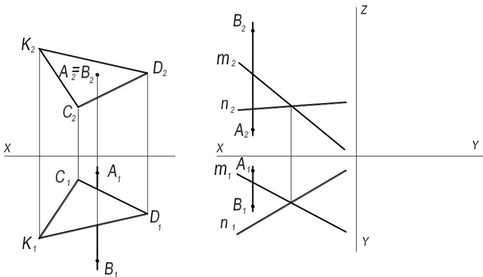
36. Построить точку пересечения прямой  $m$  с плоскостью а)  $\Omega$  (CDK), б)  $\Sigma$  ( $n \parallel d$ ). Определить видимость прямой  $m$ .
