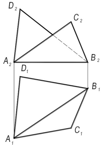
41. Преобразовать чертеж таким образом, чтобы отрезок АВ стал параллелен какой-либо плоскости проекции, применив:
