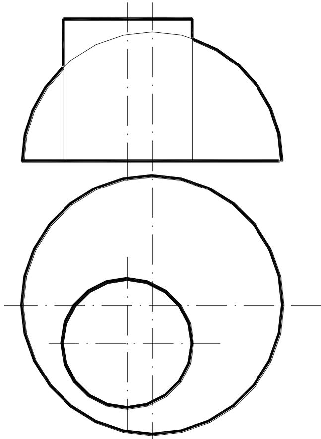
48. Построить проекции линии пересечения поверхностей тора и призмы.
