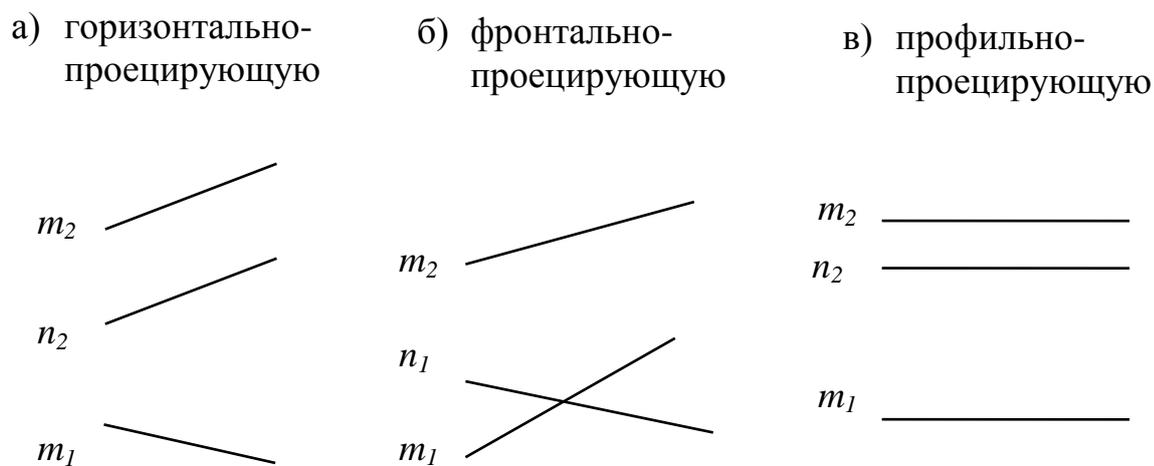
25. Задать чертеж: а) плоскости горизонтально-проецирующей – точкой и прямой; б) плоскости общего положения – точкой и прямой. В каждой из этих плоскостей провести горизонталь, фронталь и профиль.
