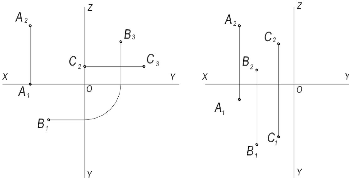
4. Обозначить элементы чертежа. Построить горизонтальные и фронтальные проекции точек A, B, C, D, E, указать углы пространства, в котором они находятся.
