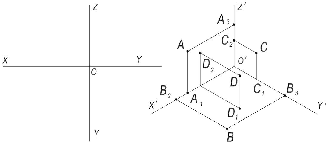
6. Обозначить элементы чертежа. Построить три проекции и наглядное изображение треугольника (ABC) по заданным координатам его вершин A (35, 15, 0), B (20, 0, 25), C (0, 30, 20).
