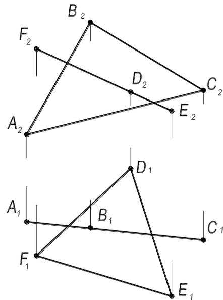
32. Построить линию пересечения проецирующей плоскости с плоскостью заданной:
