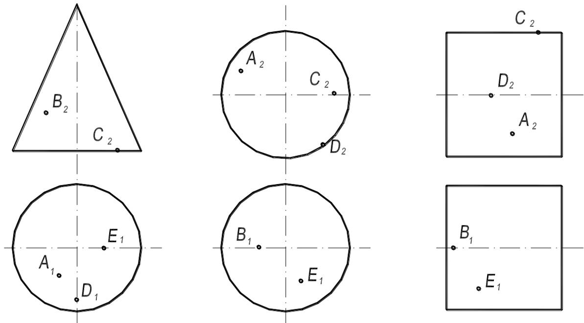
44. Построить проекции и натуральный вид сечения заданных поверхностей проецирующей плоскостью.
