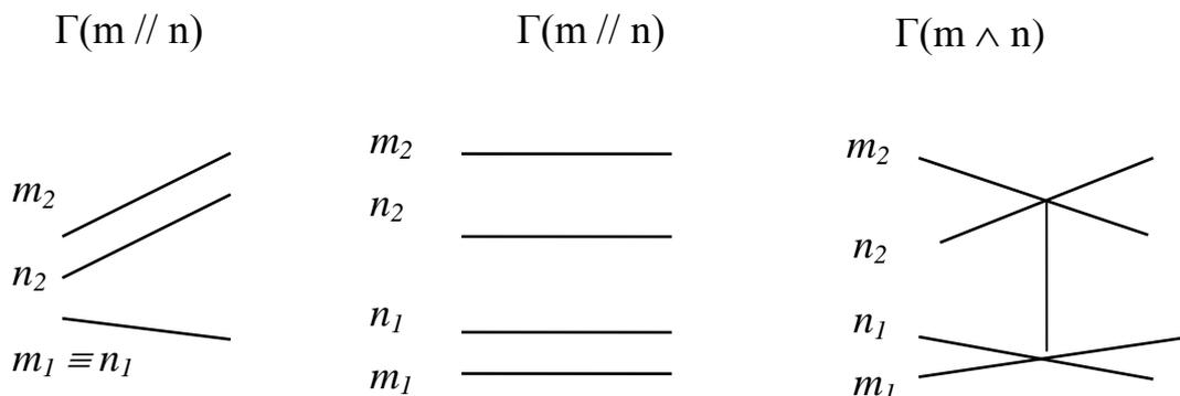
23. Плоскости заданы горизонтальными и фронтальными следами. Записать, как расположены плоскости по отношению к плоскостям проекций.
