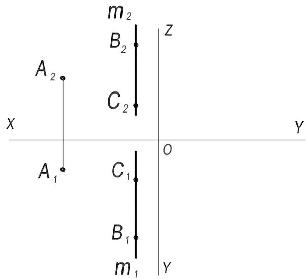
15. Через точку  $A$  провести прямую, параллельную плоскости проекций  $\Pi_1$  и пересекающую прямую  $m$ .
