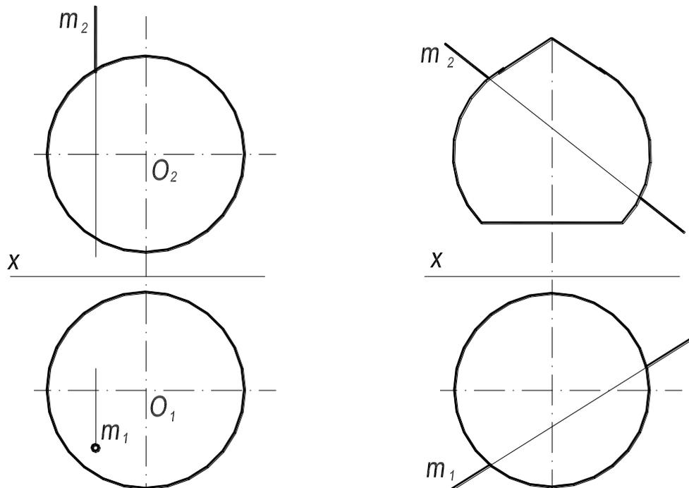
47. Построить проекции линии пересечения поверхностей сферы и цилиндра.
