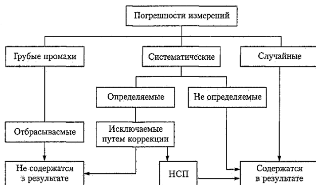
Рис. 2.1. Классификация погрешностей измерений по характеру их проявления
