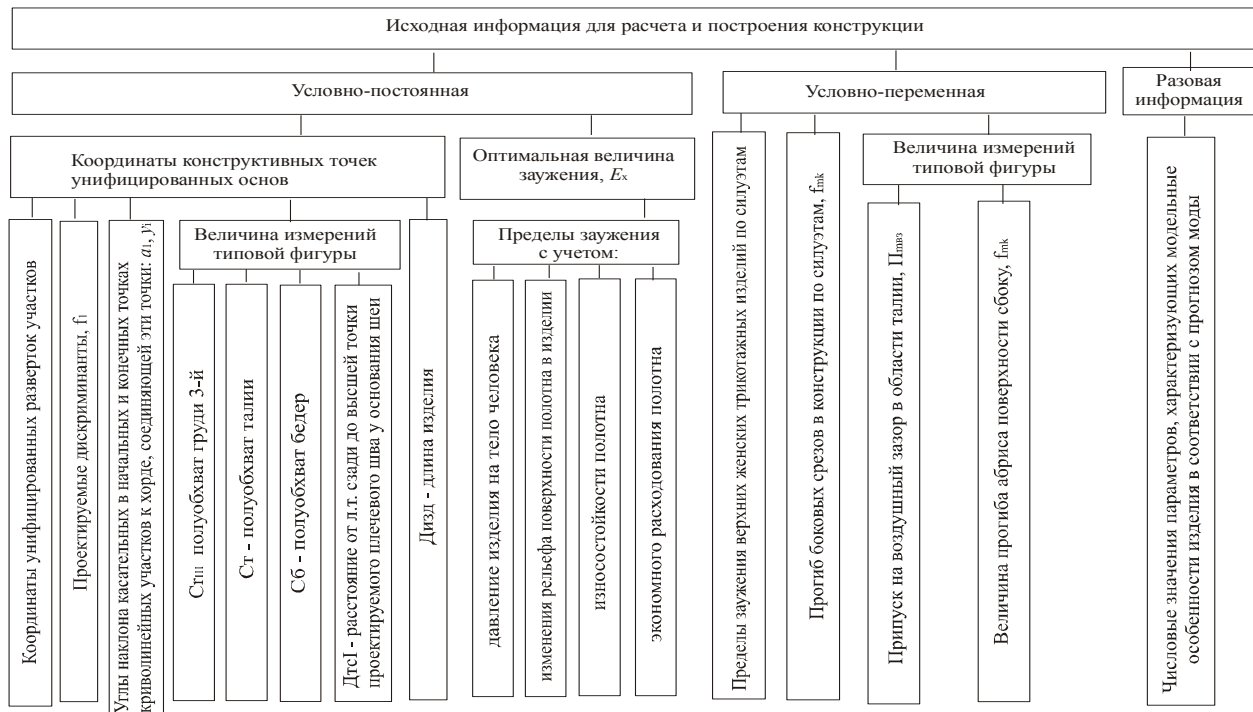
Рис. 2.3. Схема исходной информации для автоматизированного проектирования верхних женских трикотажных изделий
